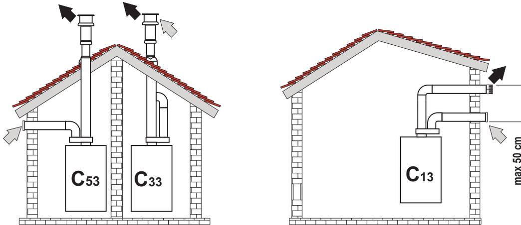
рис. 16- Примеры подсоединения с помощью отдельных труб
